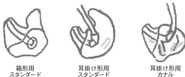
図1 イヤモールドの形状
