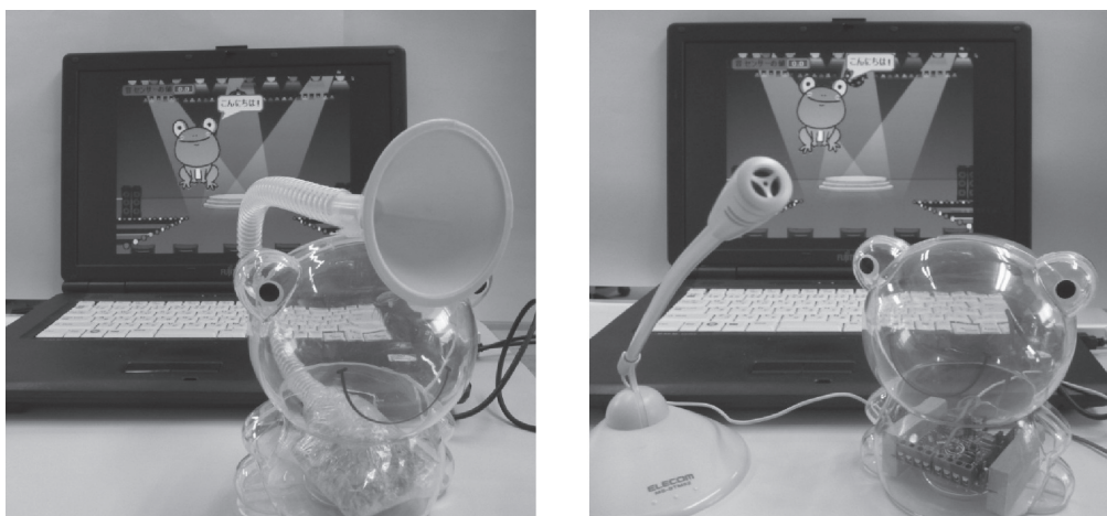
図2 センサーボードを格納した“カエル”とマイクロホン（左：幼児用、右：幼児児童用）
